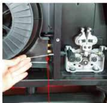
4. Vegye figyelembe a feszítő rugó beállítóját és az huzaldob helyező csapját.
