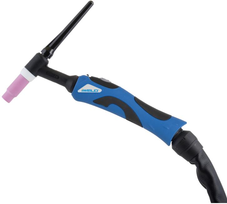
Hochwertiger WIG Schweißbrenner gasgekühlt passend zu Fronius Geräten. Gute Handhabung auch unter erschwerten Bedingungen durch die ergonomische Griffschale und das schlanke Design. Der starke Lederschutz auf der Brennerseite reduziert die Anfälligkeit des Schweißbrenners für Beschädigungen. Elektrodendurchmesser: 0,5 - 4.0 mm
