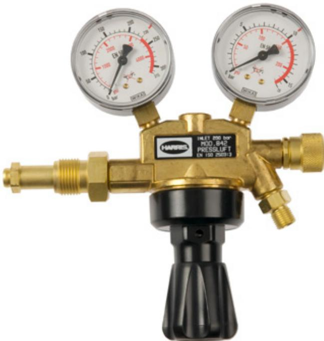
Hochwertiger einstufiger Pressluft Druckminderer in Pressmessing-Ausführung mit Manometern für den Flaschendruck und den Arbeitsdruck. Der maximale Eingangsdruck beträgt 230 bar, der maximal einstellbare Arbeitsdruck 10 bar. Hochwertige Materialien, gepaart mit dem sorgfältigen Herstellungsprozess, sorgen für einen konstanten Arbeitsdruck für beste Arbeitsergebnisse. Zur Verwendung an Druckgasflaschen des jeweiligen Flaschendrucks bei konstantem Arbeitsdruck.
